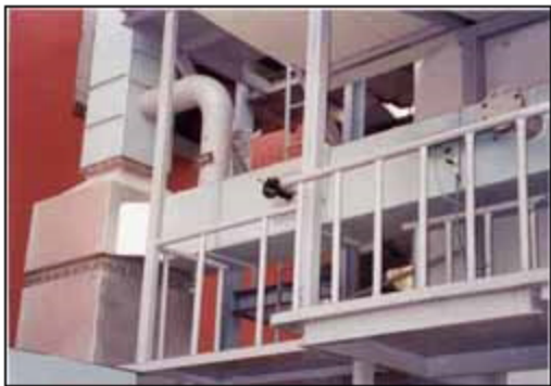
■ 减低重油粉塵實驗用锅炉設備的瓦斯管(360 x 360 mm)与 粉塵濃度測定
