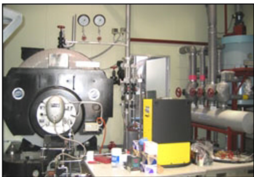
■ 减低重油粉塵實驗用锅炉
